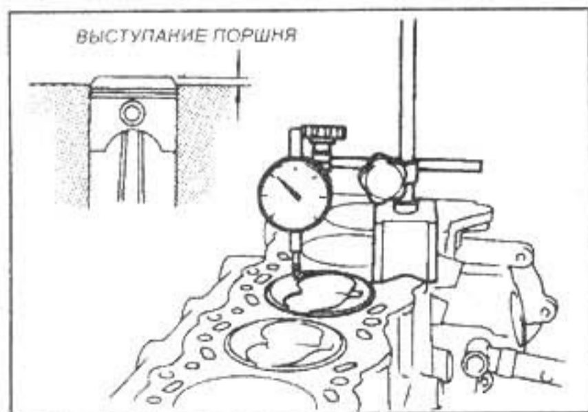
Рис. 3-64. Измерение возвышения поршней.
